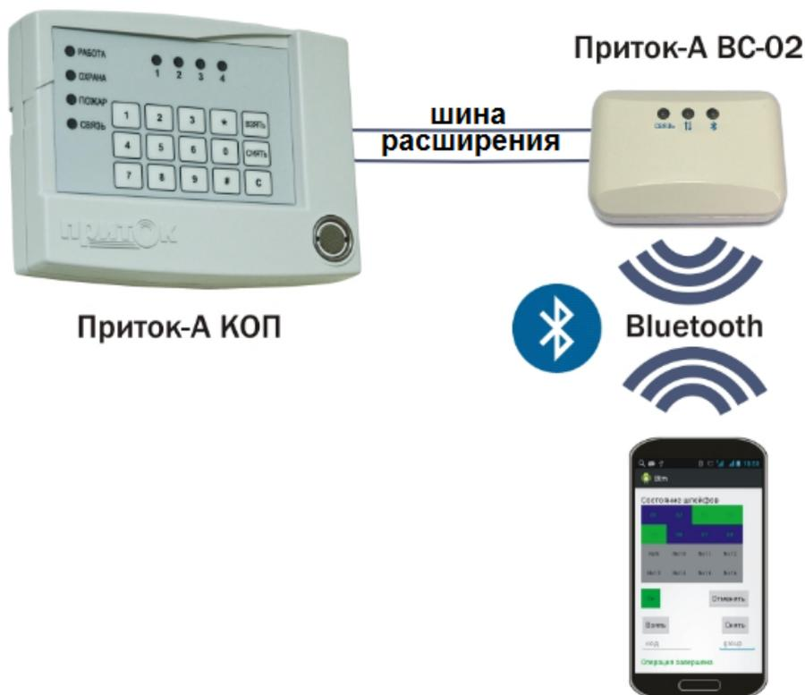
Рисунок 1 – Схема взаимодействия
